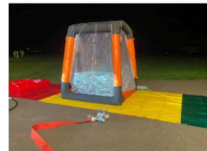
Dekontamination mit aufgebauter Dusche
